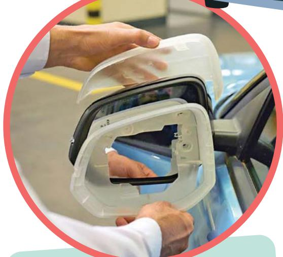
این قطعه صنعتی را هم که در خودروسازی کاربرد دارد، ساخت چاپگر سه‌بعدی است. برای ساخت قطعه‌های بسیار دقیق خودرو، چه به عنوان قطعه‌ی دیگر و چه به عنوان نمونه اولیه آزمایشی، از چاپگرهای سه‌بعدی استفاده می‌شود. کیفیت و دقت قطعه‌های تولید شده با چاپگرهای سه‌بعدی به شکل غیرقابل باوری زیاد است!
